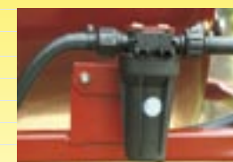
Filtros de presión (HLC)
