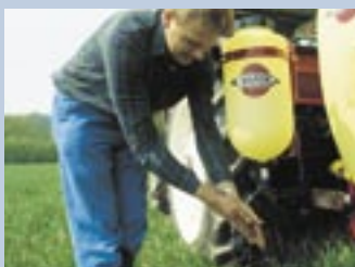
Depósito de agua limpia
