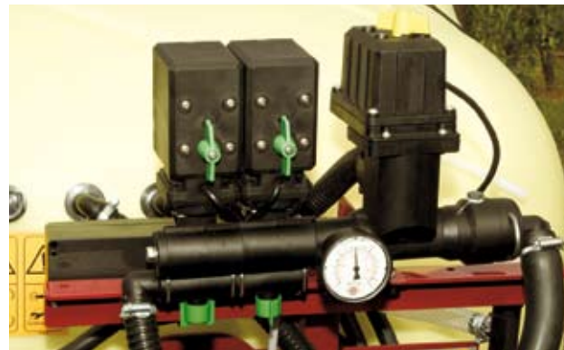
Distribuidor eléctrico EVC/2
