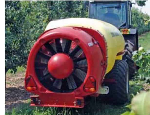
El diseño liso del depósito MERCURY previene daños en las ramas.
